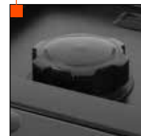
Tanque de Combustible con capacidad de 25L
