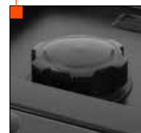
Tanque de Combustible con capacidad de 25L
